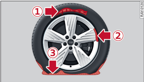
图 127 轮胎：无法修理的轮胎损坏
